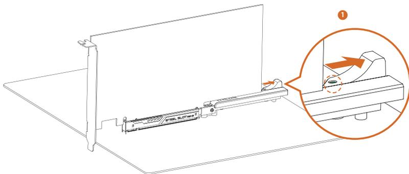
1. ラッチを右にスライドして、グラフィックカードを PCIe スロットから外します。
