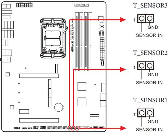
サーミスターケーブルをマザーボード上のサーミスターケーブルヘッダー (T\_SENSOR1 / T\_SENSOR2 / T\_SENSOR3) に説明します。
