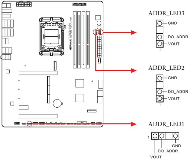
アドレスブル RGB LED ストリップをマザーボード上のアドレスブル LED ヘッダー (ADDR\_LED1 / ADDR\_LED2 / ADDR\_LED3) に接続します。
