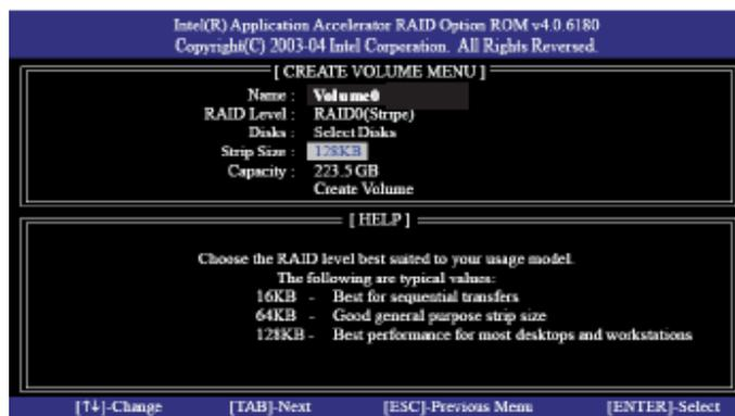
RAID 0 (ストライプ)を選ぶ場合は、「↑」キーもしくは「↓」キーを使ってRAID 0アレイのストライプサイズを選び、<Enter>を押します。使用出来る範囲は、8 KBから128 KBです。デフォルト値は128 KBです。このサイズは、ドライブの使用目的に合わせて選択します。
