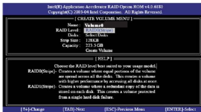
「↑」キーもしくは「↓」キーを使って希望の**RAID Level**を選びます。RAID0(ストライプ)、RAID1(ミラー)、RAID 5、RAID 10あるいはMatrix StorageをRAID levelとして選択出来ます。<Enter>を押し、**ストライプサイズ**を選びます。
