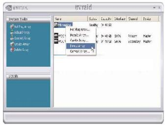
上面的截图显示一个将被删除的镜像阵列。选择"Delete Array..."(删除阵列······)之后,显示如下画面。
