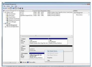
右键点击未分配的分区并选择新的简单卷。按向导设置和格式化分区。一旦完成这个步骤, 您就可以开始使用新创建的条带阵列。
