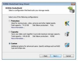
选择一种最适合您存储需求的配置。推荐选择"Custom"(自定义),点击下一步。
