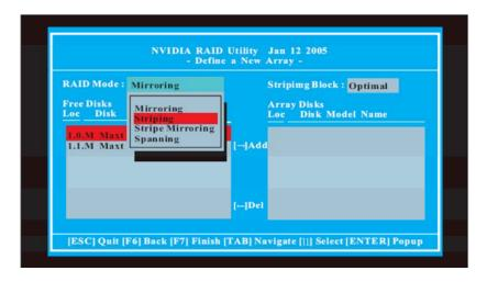
Striping block(条带块)尺寸以千字节显示,影响数据在磁盘里的分配。推荐保留默认值Optimal(最佳),即64KB,但是数值可以介于8KB和128KB之间(8,16,32,64和128KB)。然后,您指定磁盘。您从RAID Config BIOS设置页启用的磁盘就会显示在Free Disks(空闲磁盘)区块里。这些是可以用来作为RAID阵列磁盘的驱动器。
