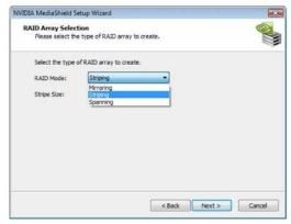
接着,选择RAID阵列的类型开始创建。首先您需要选择RAID模式,并点击下一步。这里我们以Striping(RAID 0)为例向您展示如何使用Storage(存储)创建Striping(RAID 0)。如果您计划使用Storage(存储)创建其他RAID阵列,操作流程类似于创建Striping(RAID 0)的步骤。
