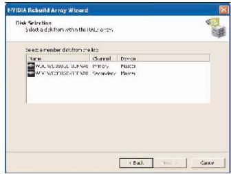
E. 通过从列表点击您想要重建的驱动器来选定它,接着点击Next(下一步)。显示 Completing the NVIDIA Rebuild Array(完成NVIDIA重建阵列)页面。
