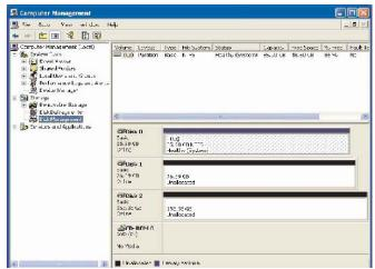
E. 153.38 GB是初期创建的由两个磁盘组成的条带阵列的容量。要在此基础上创建一个分区,请右键点击Unallocated(未分配)分区,并选择新分区。
