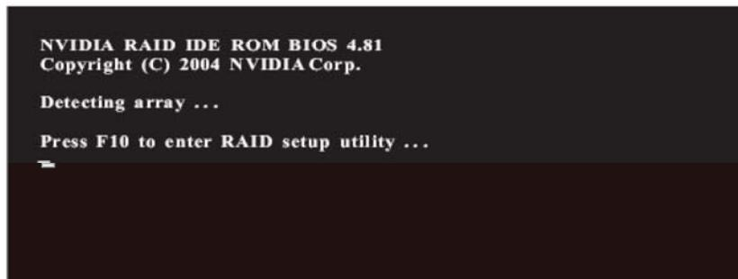
Despu s de reiniciar el equipo, espere hasta que aparezca el software RAID solicit ndole que presione la tecla <F10>. El mensaje RAID aparecer  como parte del sistema POST y el proceso de arranque antes de cargarse el OS (sistema operativo). Dispone de unos segundos para presionar la tecla <F10> antes de que la ventana desaparezca.
