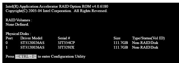
按<Ctrl+I>键，然后，出现 Intel RAID Utility – Create RAID Volume (Intel RAID 程序 – 创建 RAID 卷集) 窗口。
