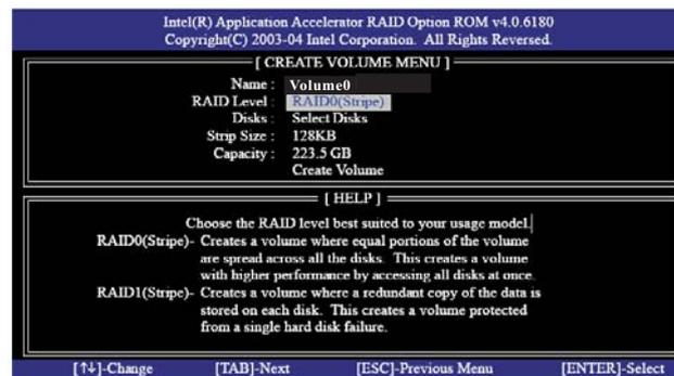
Wählen Sie das gewünschte RAID-Level mit den Aufwärts- und Abwärts-Pfeiltasten aus. Sie können RAID0 (Stripe), RAID1 (Mirror), RAID 5, RAID 10 oder Matrix Storage als RAID-Level wählen. Drücken Sie <Enter>. Danach können Sie „Strip Size“ auswählen.
