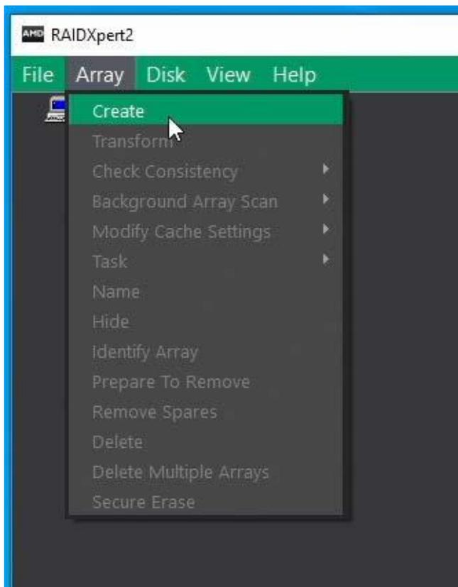
8. 選擇 RAID 類型、要用於 RAID 的磁碟、磁碟區容量，然後建立 RAID 陣列。
