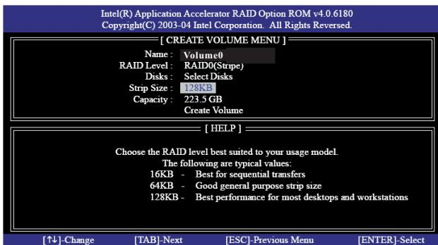
Если вы выбрали массив RAID 0 (Чередование), то с помощью стрелок вверх и вниз установите размер блока чередования для него, а затем нажмите <Enter>. Допустимые значения изменяются от 8 до 128 Кб. По умолчанию выбрано значение 128 Кб. Размер блока чередования следует выбирать в зависимости от предполагаемого использования диска.
