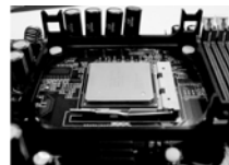
PASO 4: Empuje y Fije la Palanca del Zócalo
