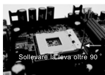
PROCEDURA 1: Sollevare la leva della presa di oltre 90° gradi
