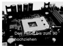
SCHRITT 1: Den Hebel des Sockels bis zum 90° hochziehen.
