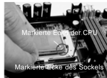
SCHRITT 2/ SCHRITT 3: Die markierte Ecke der CPU zu der markierten Ecke des Sockels anpassen.
