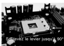
ÉTAPE 1 : Soulevez Le Levier de Douille Jusqu'à 90°
