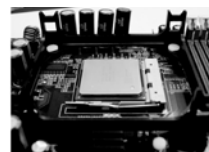
PROCEDURA 4: Abbassare e bloccare la leva della presa
