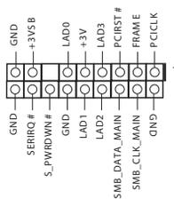
此接口支持 **Trusted Platform Module** (信任平台模块, TPM) 系统, 可以安全地存储密钥、数字证书、密码和数据。TPM 系统也可以帮助增强网络安全, 保护数字身份并确保平台完整性。
