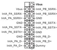
除 I/O 面板上的两个 USB 3.0 端口外, 此主板上还有一个接脚。每个 USB 3.0 接脚可以支持两个端口。
