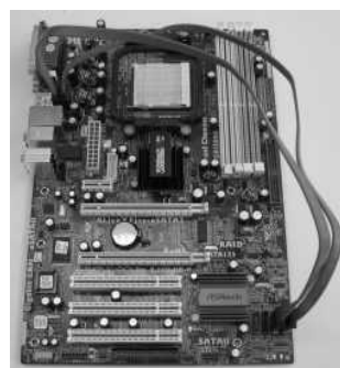
SATA データケーブルを赤い eSATAII コネクタ (eSATAII_BOTTOM) とオレンジの eSATAII コネクタ (eSATAII_TOP) の両方に接続します
