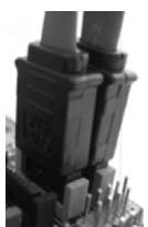
将 SATA 数据线连接到红色的 SATAII 接口 (SATAII_RED(PORT1)) 和橙色的 SATAII 接口 (SATAII_ORANGE(PORT2))
