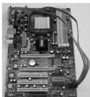
将 SATA 数据线连接到红色的 eSATAII 接口 (SATAII_BOTTOM) 和橙色的 eSATAII 接口 (SATAII_TOP)
