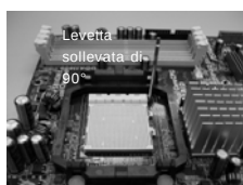
FASE 1: Sollevare la levetta socket
