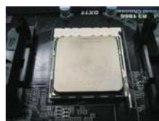
步驟 4： 下推並鎖住插座拉桿
