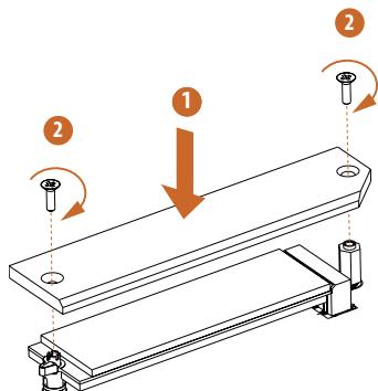
Fixieren Sie den M.2-Kühlkörper, indem Sie die Schrauben mit einem Schraubendreher anziehen. Ziehen Sie die Schraube bitte nicht übermäßig fest an, andernfalls können das M.2-SSD und der M.2-Kühlkörper beschädigt werden.
