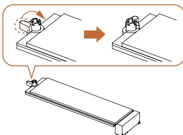
Stellen Sie sicher, dass die Kerbe am Ende des M.2-SSD an der Mutter ausgerichtet ist. Sichern Sie dann das M.2-SSD, indem Sie die Mutter im Uhrzeigersinn in die Sperrposition drehen.
