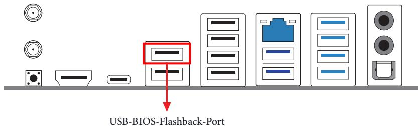
ASRocks BIOS-Flashback-Funktion ermöglicht Ihnen die Aktualisierung des BIOS ohne Einschalten des Systems, sogar ohne CPU.
